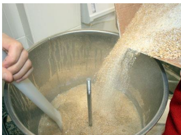
Figura 5 - Panela de aço inoxidável utilizado na brassagem (trata-se de uma panela com uma peneira de fundo falso para filtração do mosto e disponível no mercado).
