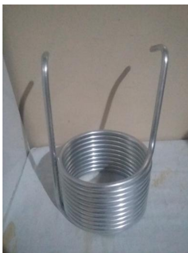
FIGURA 14 – Chiller , utilizado como trocado de calor.
