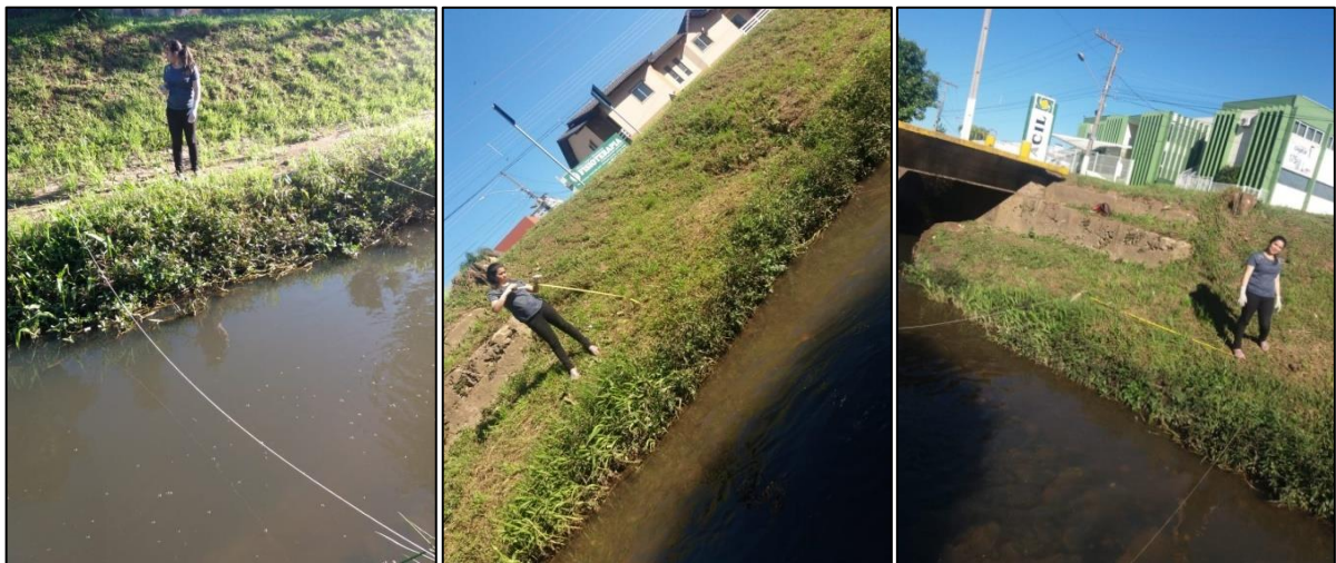
Figura 8- Medição de profundidade e velocidade média do rio carahá
